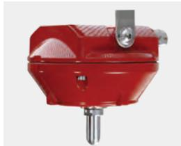
Un sensor térmico sofisticado que emitirá una alarma cuando se exceda una temperatura fija previamente establecida y cuando se detecte una tasa anormal de aumento de calor. Este detector programable de campo ofrece una función de archivo de datos que puede utilizarse para registrar un historial de temperaturas e indicar la actividad de la función.
